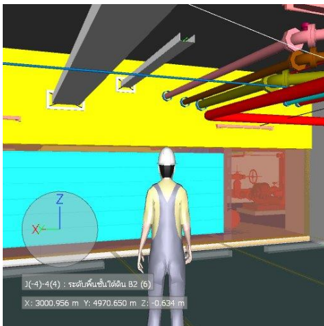
รูปที่ 1 ตัวอย่างแนวท่อนงานระบบวิ่งผ่านคานคอนกรีต
